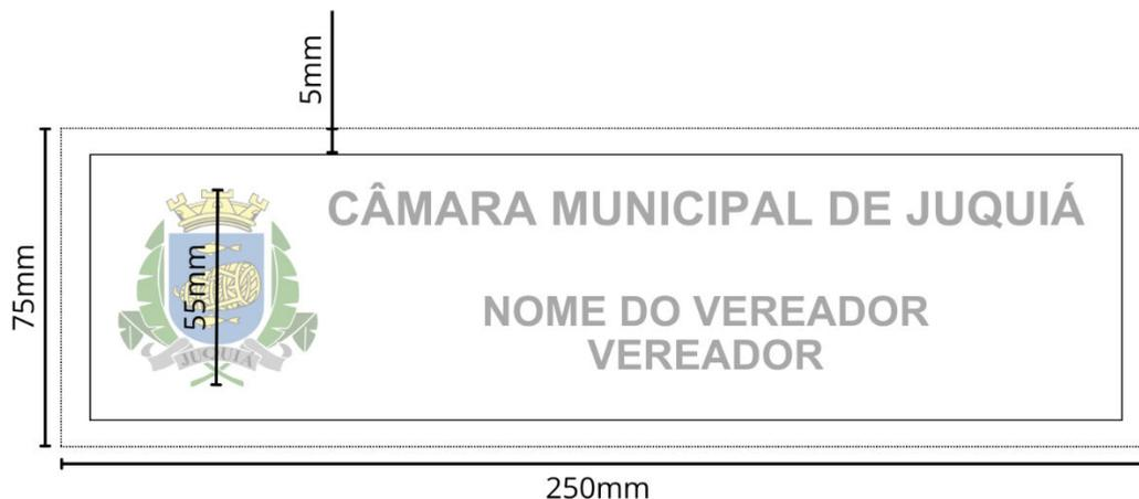
FIGURA 06 – Medidas Item 02, Prisma de Mesa 25cm x 7,5cm, abertura de 8cm, em Aço Inox, com dupla visualização e impressão digital colorida.
