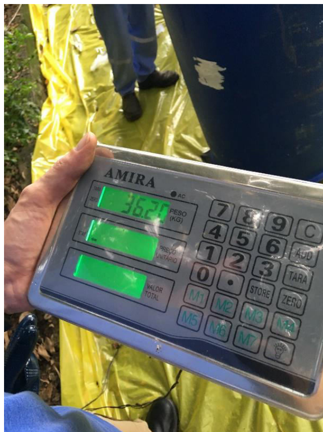
Foto 15: Balança utilizada na gravimetria (cap. 300kg)
